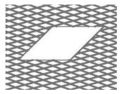
Sehr oft müssen Einbauten, wie Downlights auch in die Deckenelemente festgeklemmt werden, wo die spitz zulaufenden Maschenenden keinen Halt geben. Dann empfehlen wir das Aufschweißen von 1,5mm starken Verstärkungsringen gemäß den unteren Detailvorschlägen
