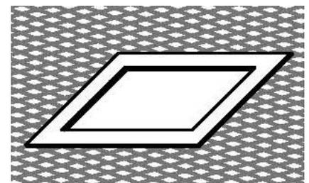
Gelegentlich sind auch Aufkantungen notwendig, ähnlich der Ausführung der Kantung E1 oder mittels L-Winkel, wie zum Beispiel auf dem Detail rechts aufgeführt.
