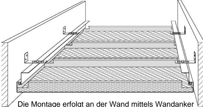
Die Montage erfolgt an der Wand mittels Wandanker
