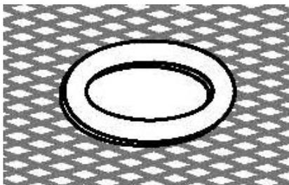
Meist werden die Ausschnitte mit einem Verstärkungsring versehen, was dann die glatte Fläche ähnlich einer Gipskartonplatte oder Metalldecke imitiert.
