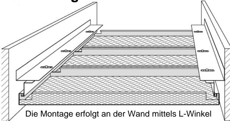
Die Montage erfolgt an der Wand mittels L-Winkel
