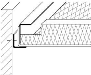
Die Streckmetallkassetten werden auf einem Stufenwinkel (rechts) oder L-Winkel (links) aufgelegt. Die Streckmetallkassetten können auch angeschnitten werden und durch einem zusätzlichen L-Winkel fixiert werden.
