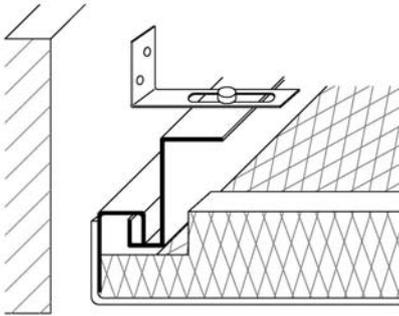
Die Streckmetallkassetten werden auf Passmaß gefertigt und werden im Wandbereich mit offener Schattenfuge (links mit Wandanker) oder mit geschlossener Schattenfuge (rechts) eingehängt. Die Kassetten sind einfach revisionierbar.
